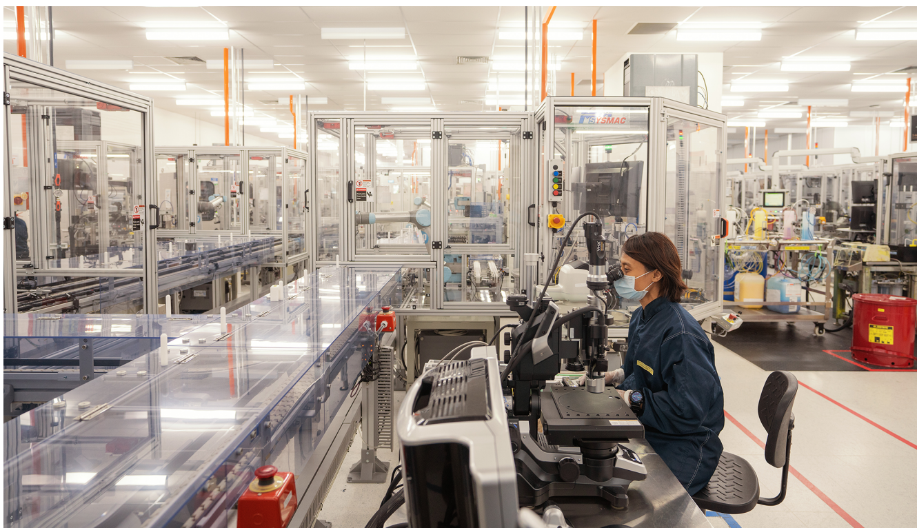
HPの生産ラインの様子。コンベヤーに取り付けられた高性能カメラ付き顕微鏡を使って製品の品質検査が行われている。製品を取り外すことなく検査できるため、汚染リスクを最小限に抑えられる
