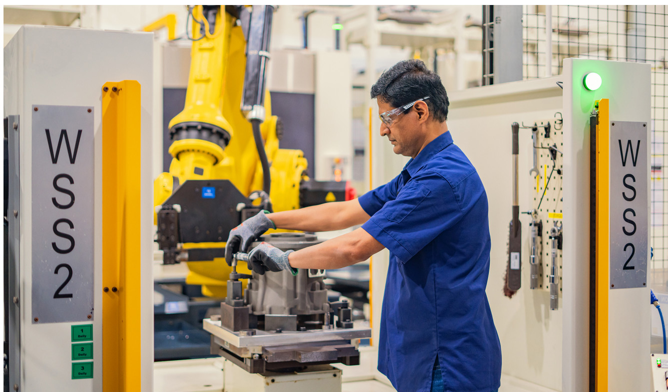
ベドックにあるコリンズ・エアロスペースの工場。技術者が航空機部品の整備を行う傍ら、最大80kgの部品を運ぶ自動ロボットアームが活躍している
