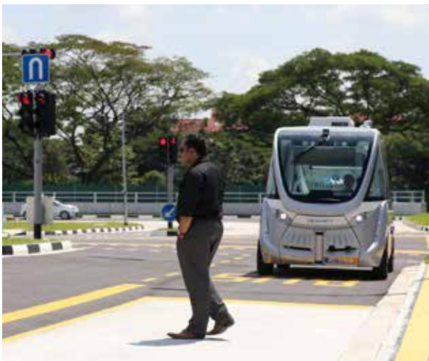
无人驾驶车测试中心根据新加坡路况而设计，除了巴士站和交通灯等公路设施，也模拟行人过马路等不同交通情况的运作。
